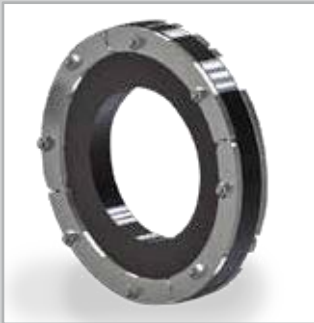
RRD1 gyűrűs tértömítés EPDM-gumiból, egyrétegű, nem víznyomásálló kivitel, A2 minőségű nemesacél fémalkatrészek.
