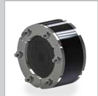
RDZ2 hagymaprofilos gyűrűs tömítés EPDM-gumiból, kétrétegű, víznyomásálló kivitel, A2 minőségű nemesacél fémalkatrészek.
