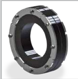
RRD2 gyűrűs tértömítés EPDM-gumiból, kétrétegű, víznyomásálló kivitel, A2 minőségű nemesacél fémalkatrészek.
