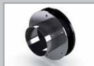
Előkarima Magfurat előtti tömítésre szolgál, falban vagy mennyezetben. EPDM-karimatömítéssel és rögzítőelemekkel szállítjuk. Nemesacél kivitel.
