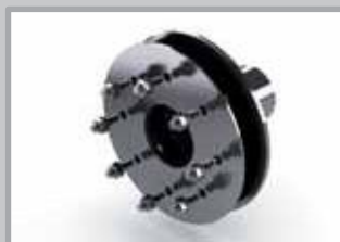
Rögzített / szabad karimás béléscső Szigetelőhornyok (bitumenes) szigeteléséhez a DIN 18 195 szabvány 9. fejezete szerint. Nemesacél kivitel. Belső átmérő: 60 – 2 000 mm
