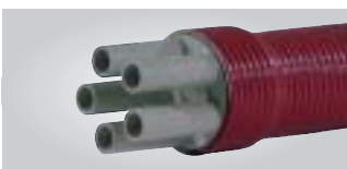
System-Deckel D5 mit 5 Stutzen zur Abdichtung von Kabeln mittels Schrumpftechnik. Lieferbar für System: KSS 85: D5-20 (für 5 Kabel von 7 bis 18 mm \varnothing )
