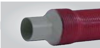
System-Deckel D1 mit 1 Stutzen zur Abdichtung eines Kabels mittels Schrumpftechnik. Lieferbar für System: KSS B150, KSS 150: D1-110 (für 1 Kabel von 34 bis 108 mm \varnothing ) KSS B150, KSS 150, KSS 110: D1-80 (für 1 Kabel von 26 bis 78 mm \varnothing ) KSS 85: D1-75 (für 1 Kabel von 26 bis 73 mm \varnothing )
