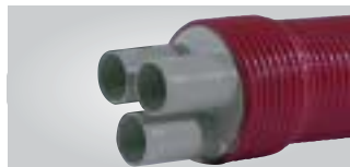
System-Deckel D3 mit 3 Stutzen zur Abdichtung von Kabeln mittels Schrumpftechnik. Lieferbar für System: KSS B150, KSS 150, KSS 110: D3-46 (für 3 Kabel von 16 bis 44 mm \varnothing ) KSS 85: D3-30 (für 3 Kabel von 12 bis 28 mm \varnothing )
