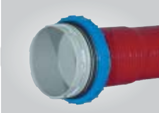
Systemanschluss D (für BKD 150) Lässt sich gas- und wasserdicht mit einer Bayonett-Dichtpackung verbinden. Lieferbar für System: KSS B150
